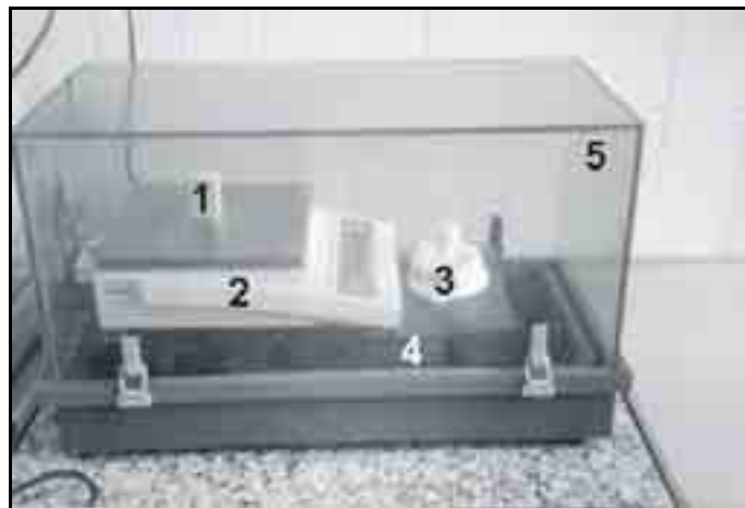
Fig. 5-1. El dispositivo experimental consta de la roca (1), la balanza (2), el medidor de temperatura y humedad relativa (3), el gel de sílice (4). El dispositivo está herméticamente cerrado (5).
