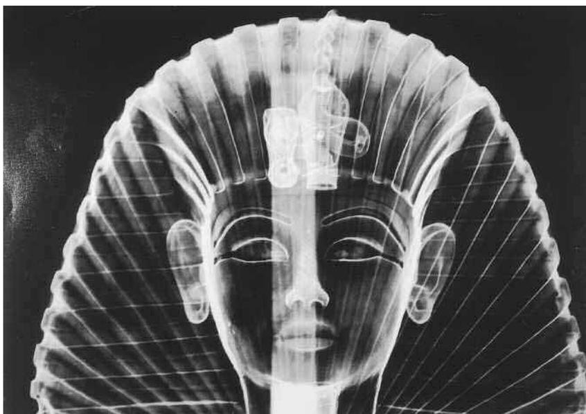
Figura 7: Extraordinaria gammagrafía de la máscara de oro del faraón Tut-Ankh-Amon, realizada con el isótopo radiactivo Cobalto-60.
