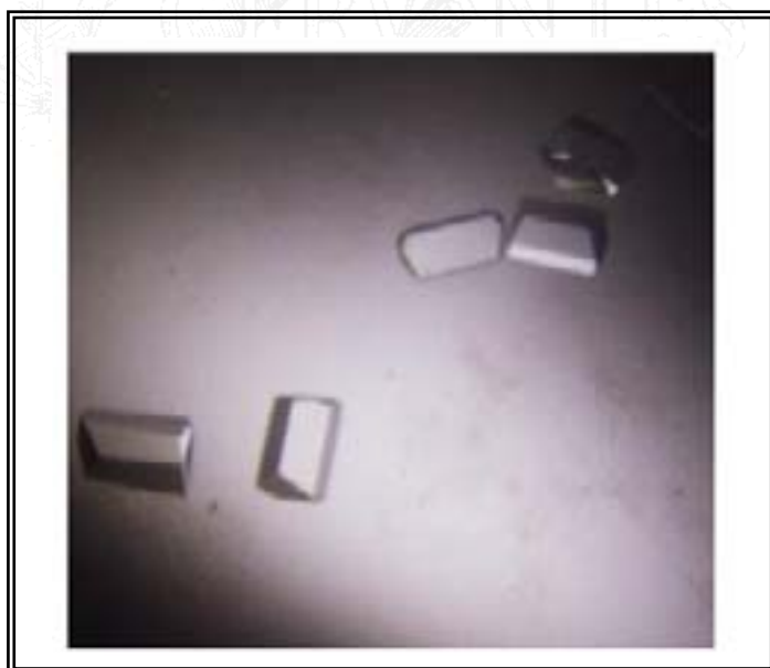
Figura 92: Cristales obtenidos a partir del complejo binario GlcDH D172K D216K D344K- NADP^+ en presencia de zinc.
