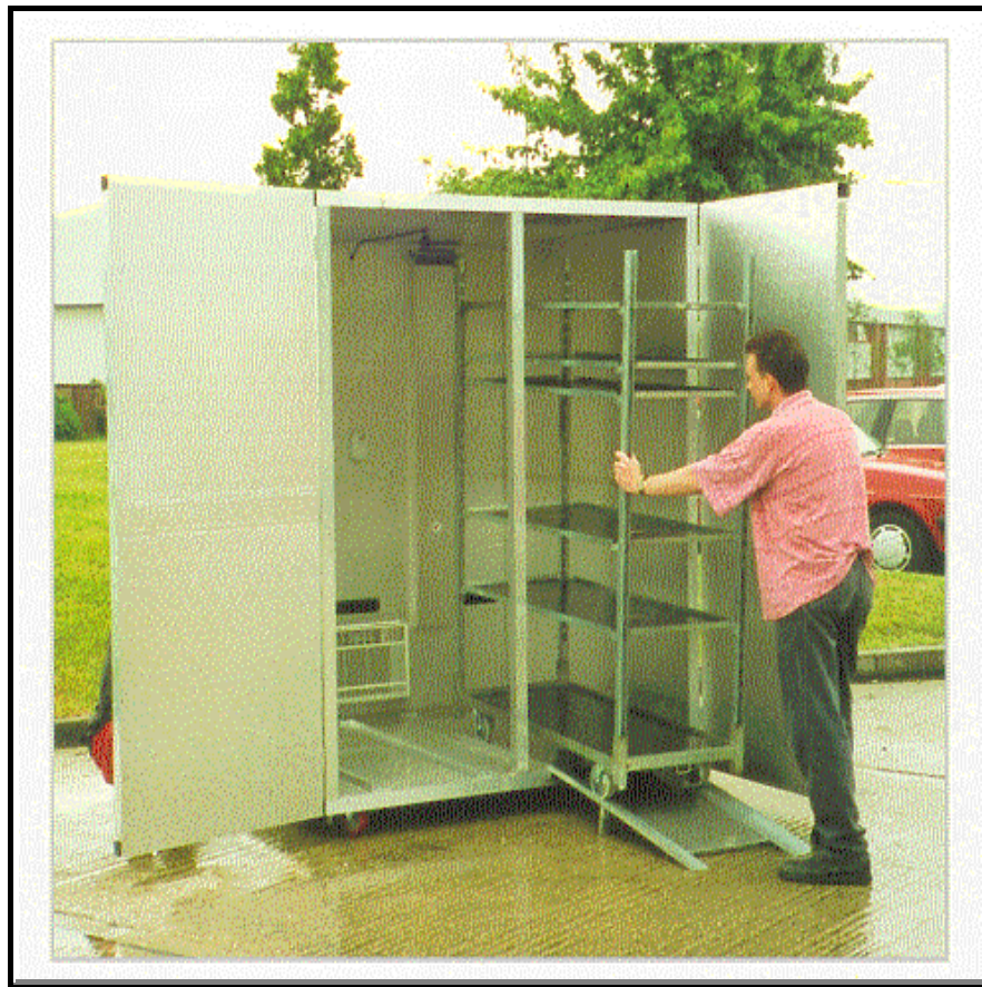
Figura III.7a. Detalle de la cámara de cultivo utilizada en el ensayo.
