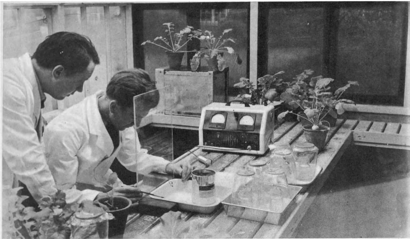
SIGUIENDO LA PISTA DE LOS INSECTOS NOCIVOS con los radio-isótopos. En la estación experimental de Rhothamstead, Harpenden (Inglaterra) los hombres de ciencia llevan a cabo una serie de experimentos sobre los áfidos o familia de pulgones. Aquí se marca a uno de éstos, con pintura radioactiva, antes de ponerlo en libertad sobre una planta de nabo. Los radio-isótopos revelarán el rumbo de la migración de los insectos de planta en planta. (Foto COI Crown Copyright reservado).
