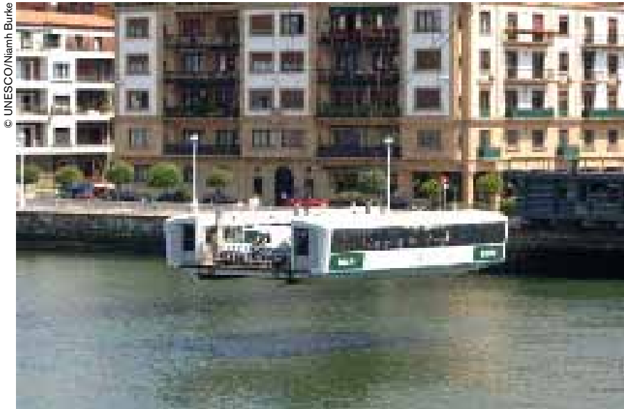
La barquilla suspendida bajo el puente permite transportar personas.
