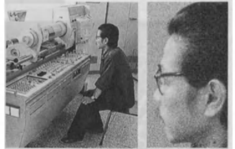
28. El analizador es un aparato electrónico utilizado para el tratamiento de imágenes destinadas a la impresión. La imagen se fija en un cilindro giratorio y el analizador la reproduce en una multiplicidad de puntos. A la derecha, ampliación de los puntos para tonos intermedios.
