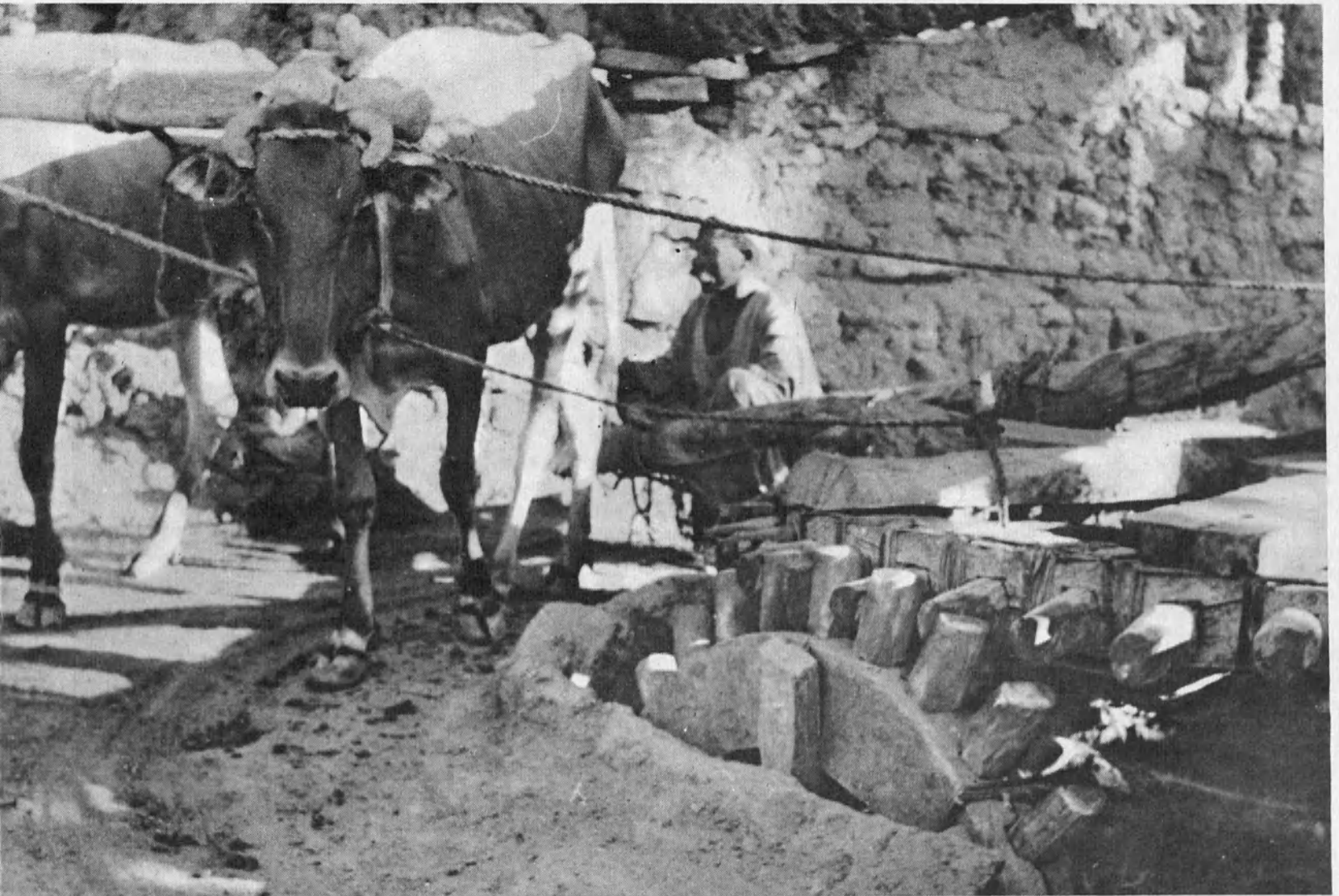
ANTIGUA RUEDA movida por una yunta de bueyes, empleada para extraer agua de riego en el Delta del Nilo. Los aparatos de riego son ciertamente primitivos, pero el esfuerzo infatigable y la habilidad de los fellahs han hecho de esta tierra una de las más productivas del mundo. (Foto Unesco.)
