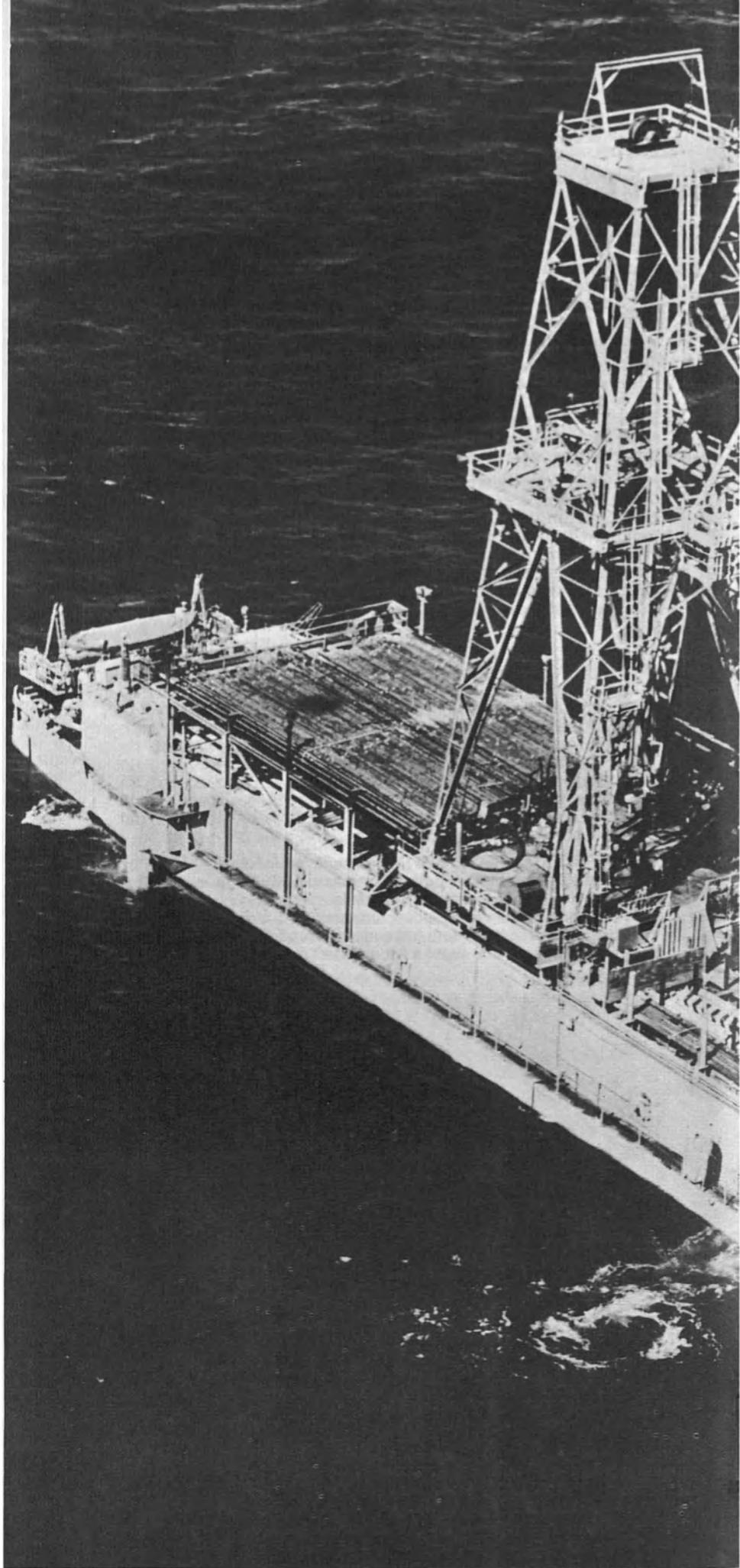
Para obtener muestras del manto terrestre (véase diagrama a la izquierda) los científicos norteamericanos se proponen perforar la corteza superior en las partes en que ésta es más delgada (cerca de cuatro kilómetros). El objetivo que desean alcanzar es el límite entre la corteza y el manto, llamado vertiente o discontinuidad de Mohorovicic.
