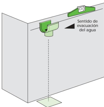
**6** Fijar los ganchos intermedios siguiendo la inclinación y con un separación de 40 cm como máximo.
