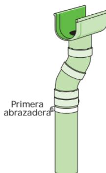
**4** Fijar las abrazaderas al muro con mortero de sellado o con tacos. Las bajantes y desviaciones han de estar dispuestas a unos 2 cm del muro.
