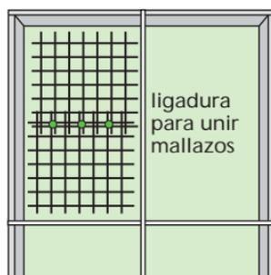
No unir entre sí paneles que pertenezcan a secciones distintas con el fin de ahorrarse una junta de dilatación.
