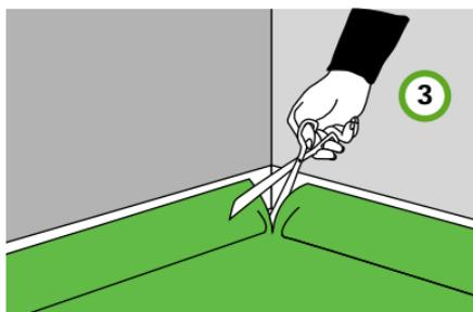
**3** Para que el revestimiento se adapte bien a los rincones y esquinas, realizar un corte recto en todos los ángulos.
