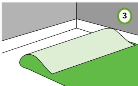
**3** Plegar una mitad del revestimiento sobre sí mismo. Retirar la banda protectora de la cinta en la zona del suelo que ha quedado despejada. Extender el revestimiento en esta mitad de la habitación, estirándolo hacia el rodapié con la mano. Repetir esta operación con la otra mitad del revestimiento.
