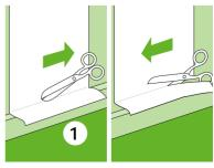
2 En el encuentro con el rodapié, se puede utilizar un cutter, apoyándolo en una regla, para guiar el corte.
