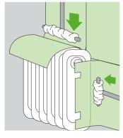
Si no hay posibilidad de desmontar el radiador: para que la tira de papel pueda pasar por detrás del radiador, hay que realizar unos cortes verticales que permitan rodear los tubos y soportes.
