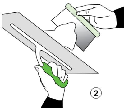
3 Trabajar por bandas de 1,50 m de ancho. Empezar por la parte baja de la pared, ejecutando pasadas regulares de unos 15 mm de grosor. Presionar fuertemente la llana sobre el fondo con movimientos circulares o verticales según el aspecto deseado.
