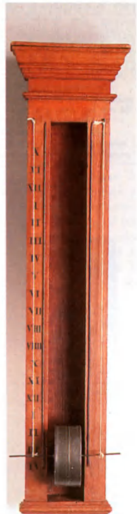
Clepsidra francesa de tambor, principios del siglo XIX. El agua contenida en el tambor, al fluir lentamente, lo hace girar. Gracias a los cordeles enrollados en torno a su eje, el tambor, al girar, desciende frente a las graduaciones indicadas en los largueros.
