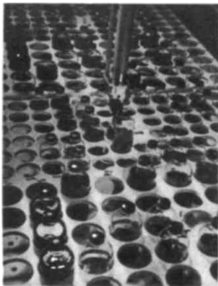
LA MAYOR PARTE DE LOS ISOTOPOS se conservan en soluciones líquidas. Los expertos, protegidos por un muro espeso, operan mediante un espejo (los rayos radioactivos tienen una acción lateral y no vertical). Los recipientes son llenados y retirados gracias a un ingenioso sistema que ejecuta perfectamente...
