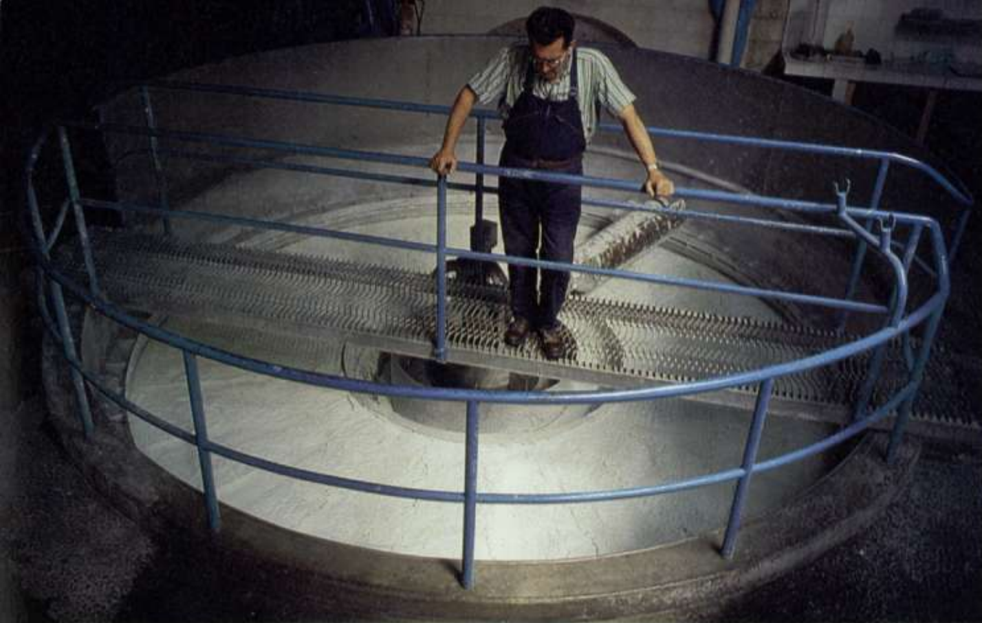
Un técnico supervisando la preparación de la pasta de papel.
