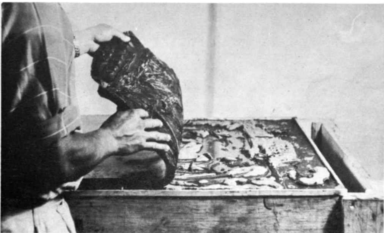
Después de hecho el grabado sobre cera, se vierte sobre ésta una mezcla de glicerina y cola de carpintero. El clisé resultante (visto aquí en el momento de sacarlo) tiene textura de goma y se usa directamente para la impresión.
