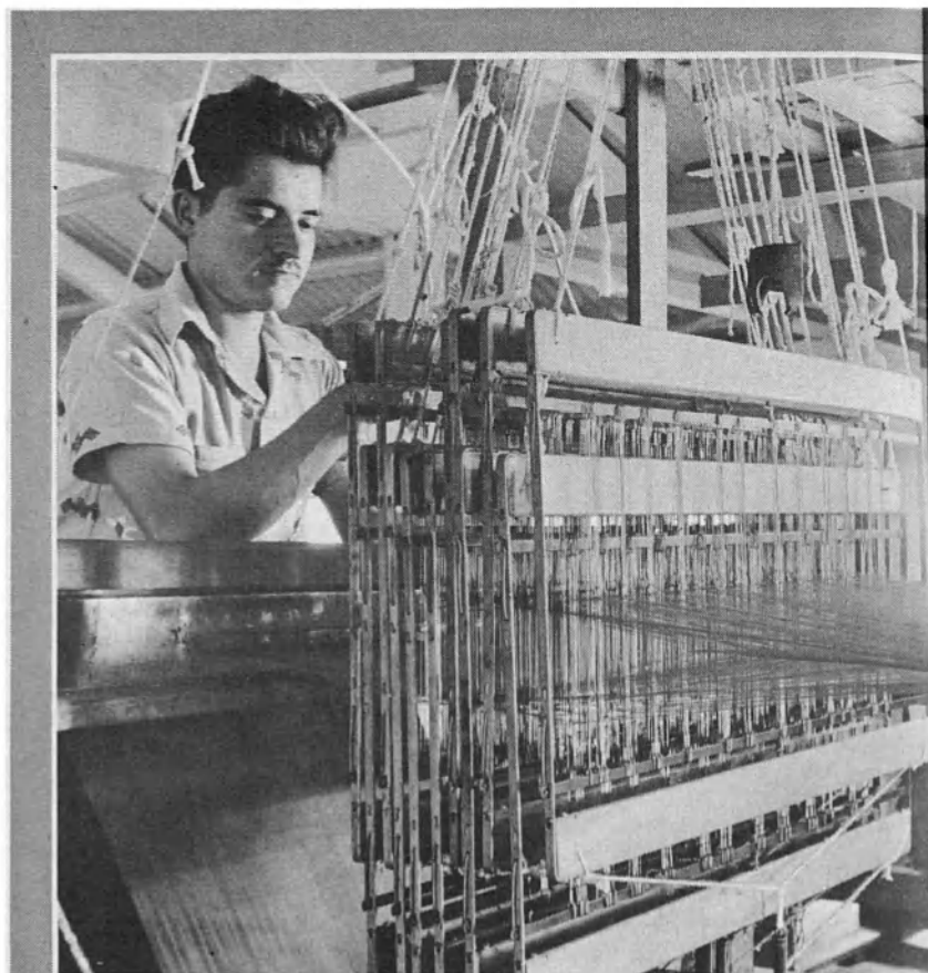
A LOS APRENDICES TEJEDORES de Guatemala se le enseña ahora la manera de conservar los famosos dibujos maya de su país y, al mismo tiempo, de intensificar la producción. La clave de este aprendizaje es un aparato Jacquard, de fabricación nacional —con un cerebro mecánico que fija el modelo.
