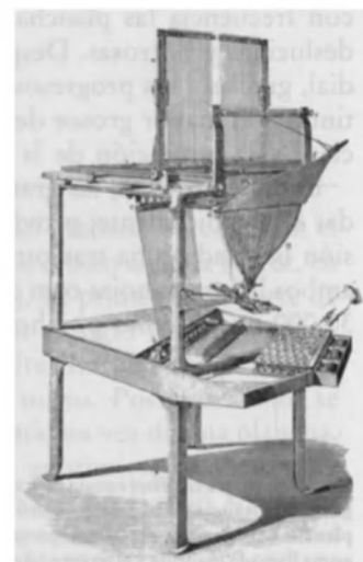
20. La máquina de composición tipográfica de Hattersley, Londres, hacia 1870.
