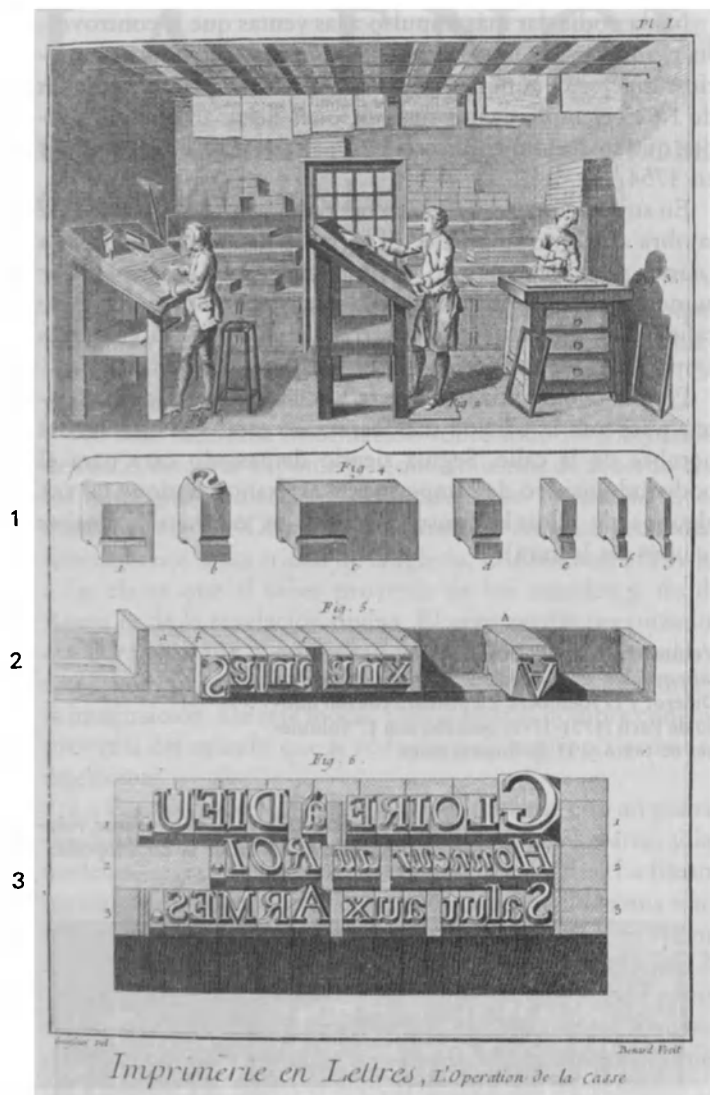
Imprimerie en lettres, l'opération de la casse (La imprenta en letras, la operación de la caja), lámina de la Enciclopedia de Diderot y D'Alembert que muestra las operaciones sucesivas del trabajo del tipógrafo. Arriba a la izquierda, éste retira "plomos" de la caja, como la "S" mayúscula y los "espacios" (blancos que separan las palabras) más o menos finos que aparecen en la fig. 1, y los ensambla en una especie de regla, el "componedor", para formar una línea (fig. 2). En el centro, el tipógrafo monta las líneas así compuestas en una suerte de bandeja de madera, la "galera", instalada sobre un pupitre. A la derecha, coloca al mismo nivel todas las galeras; éstas constituyen la forma.
