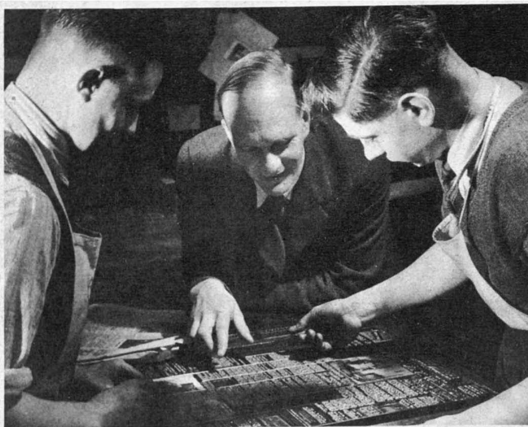
La "platina" de un diario es el lugar de la imprenta en que el plomo —es decir, el conjunto de las líneas compuestas con cajas de mano o con linotipo— se reúne y se dispone en las formas. El periodista (en el centro) guía a los tipógrafos de modo que, una vez impresa, la página toma el aspecto al que están acostumbrados los lectores del periódico. (Foto C.O.I.)
