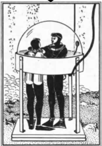
CABINA TELEFONICA. Semiesfera de plexiglás, de 1,20 metros de diámetro, a la que se bombea aire fresco desde la superficie. En ella caben de pie cuatro buceadores que pueden comunicarse entre sí o con la tripulación. Además constituye una reserva de aire para los casos de emergencia. (Véase también la fotografía de arriba.)
