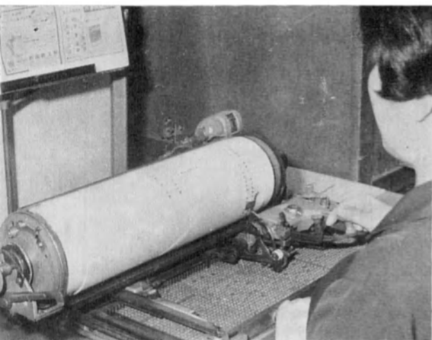
La dactilógrafa japonesa dispone de una sola tecla pero de 3 130 caracteres (o más) dispuestos en un tablero horizontal. Antes de golpear la tecla, la lleva, junto con su palanca, encima del carácter correspondiente (foto de abajo). En el papel (arriba) se imprimen los caracteres alineándose verticalmente o, si se quiere, horizontalmente.
