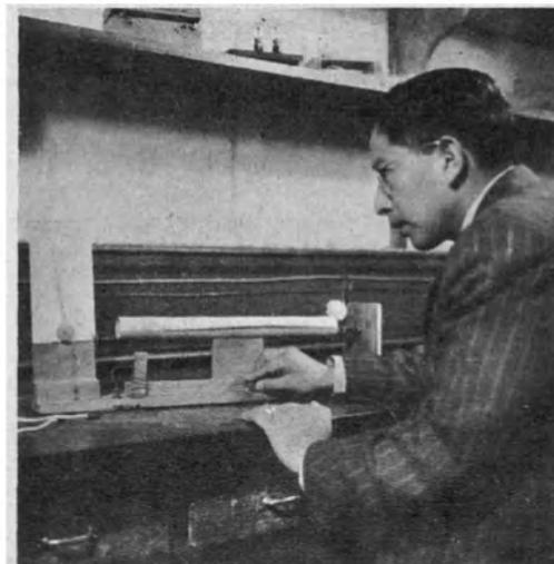
**LA EXPANSION DE LOS METALES** sujetos al calor producido por una corriente eléctrica puede ser medida en este «extensómetro» —de fabricación local— manejado por Mesías Huaranga, miembro del equipo de maestros de Física. El tubo de papel que rodea al alambre le impide enfriarse por las corrientes de aire durante el experimento.
