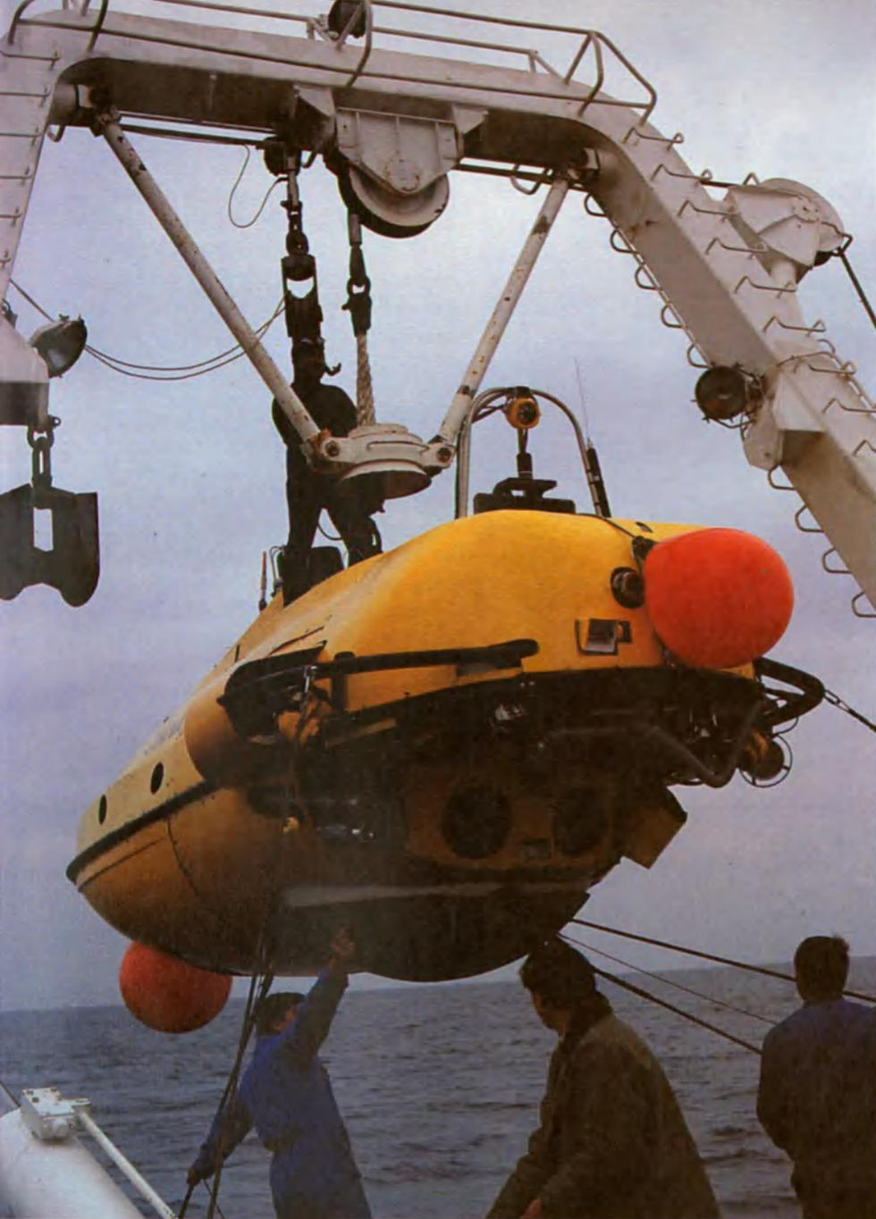
Arriba, el submarino Cyana, con sus tres tripulantes, puede llegar a 3.000 metros de profundidad. Se utiliza con fines industriales o científicos.
