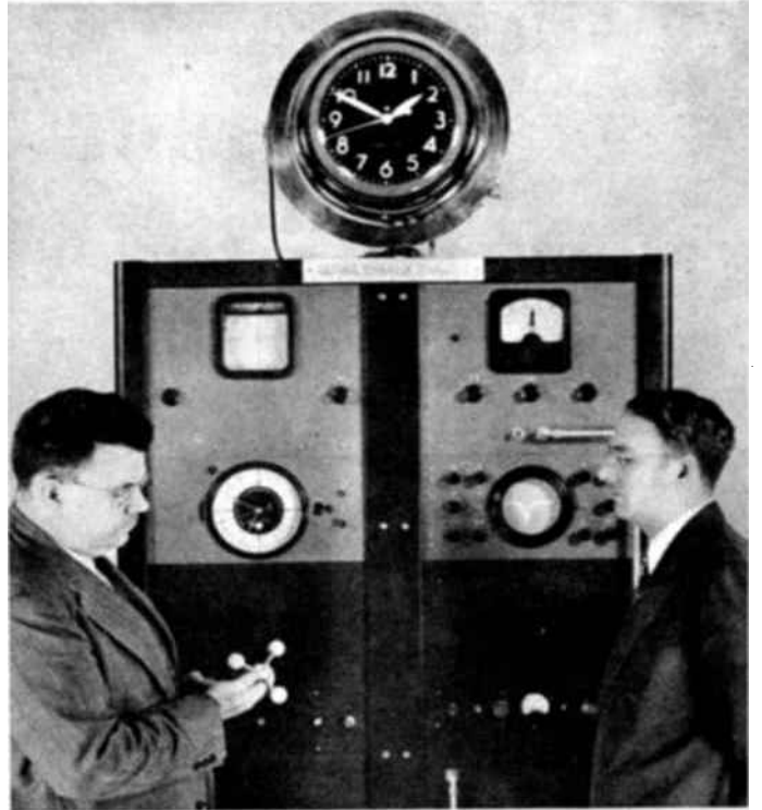
EL RELOJ DE LA EDAD ATOMICA. Apartándose de todos los métodos convencionales de medición del tiempo, la Oficina Nacional de Pesas y Medidas de Washington ha fabricado un reloj atómico — independiente de toda observación astronómica. Este invento se basa en la frecuencia normal de las oscilaciones atómicas en la molécula de amoníaco, y ofrece la particularidad de no depender en absoluto de la medición tradicional del tiempo, influida por la rotación de la tierra sobre su eje y el movimiento de ésta alrededor del sol. En efecto, esa medición tradicional no es exacta, ya que se ha podido observar que el eje de la tierra padece ligeras oscilaciones y que, asimismo, ciertas fluctuaciones retardan o aceleran la traslación de la tierra en el sistema solar. Así, el nuevo método nos ofrece una hora invariable. En esta foto vemos (a la izquierda) al Dr. E. U. Condon, Director de la Oficina Nacional de Pesas y Medidas, y al Dr. Harold Lyons, inventor del reloj. El Dr. Condon tiene en la mano un modelo de la molécula de amoníaco, cuya absorción de radio produce la frecuencia invariable en que se basa el mecanismo de control.
