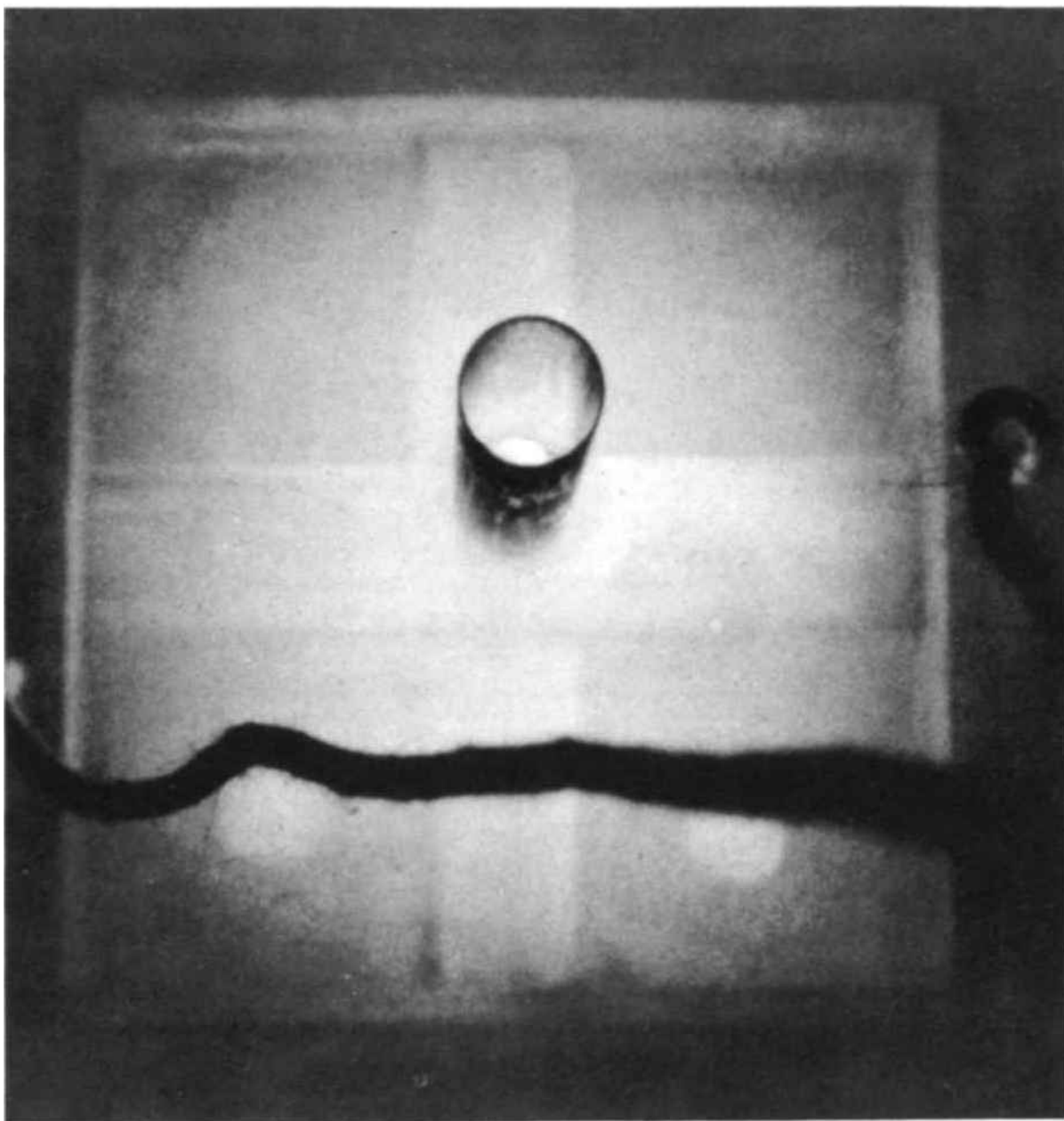
DISPOSITIVO QUE CONTIENE COBALTO RADIOACTIVO , utilizado en el Laboratorio de Brookhaven para el estudio y aprovechamiento de las radiaciones gamma. Esta fotografía ha sido tomada a la luz de esas radiaciones únicamente. La sombra negra representa una de las dos cuerdas que han servido para hacer funcionar el aparato.
