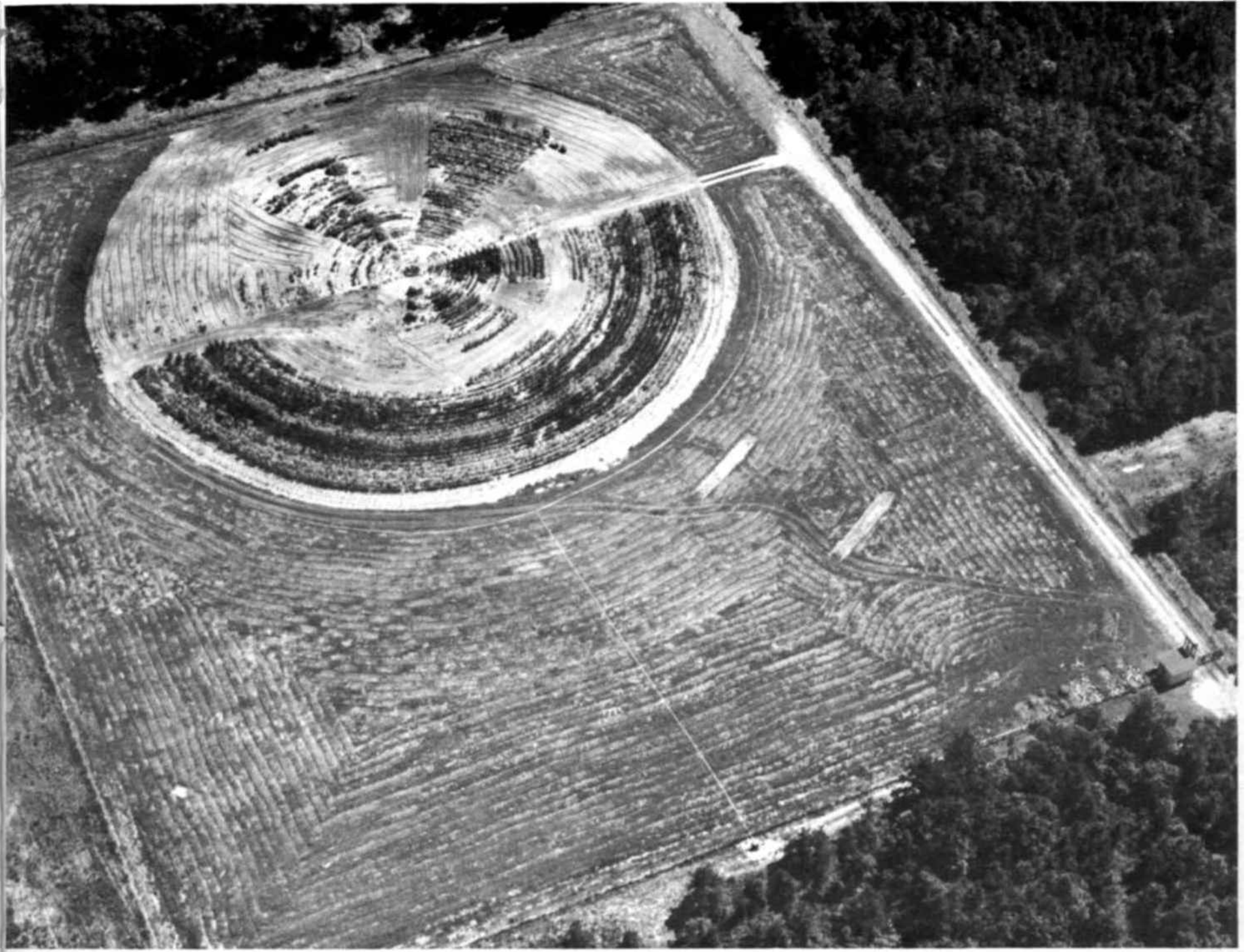
VISTA GENERAL AÉREA de un campo del Laboratorio Nacional de Brookhaven, Nueva York, que se utiliza para instalaciones experimentales con radiaciones nucleares. Se planta maíz y otros productos en surcos circulares alrededor de una fuente central de radiación con radiocobalto. Las mutaciones y demás cambios en la estructura celular de las plantas se inducen exponiéndolos a los rayos gamma emitidos por el cobalto radioactivo.
