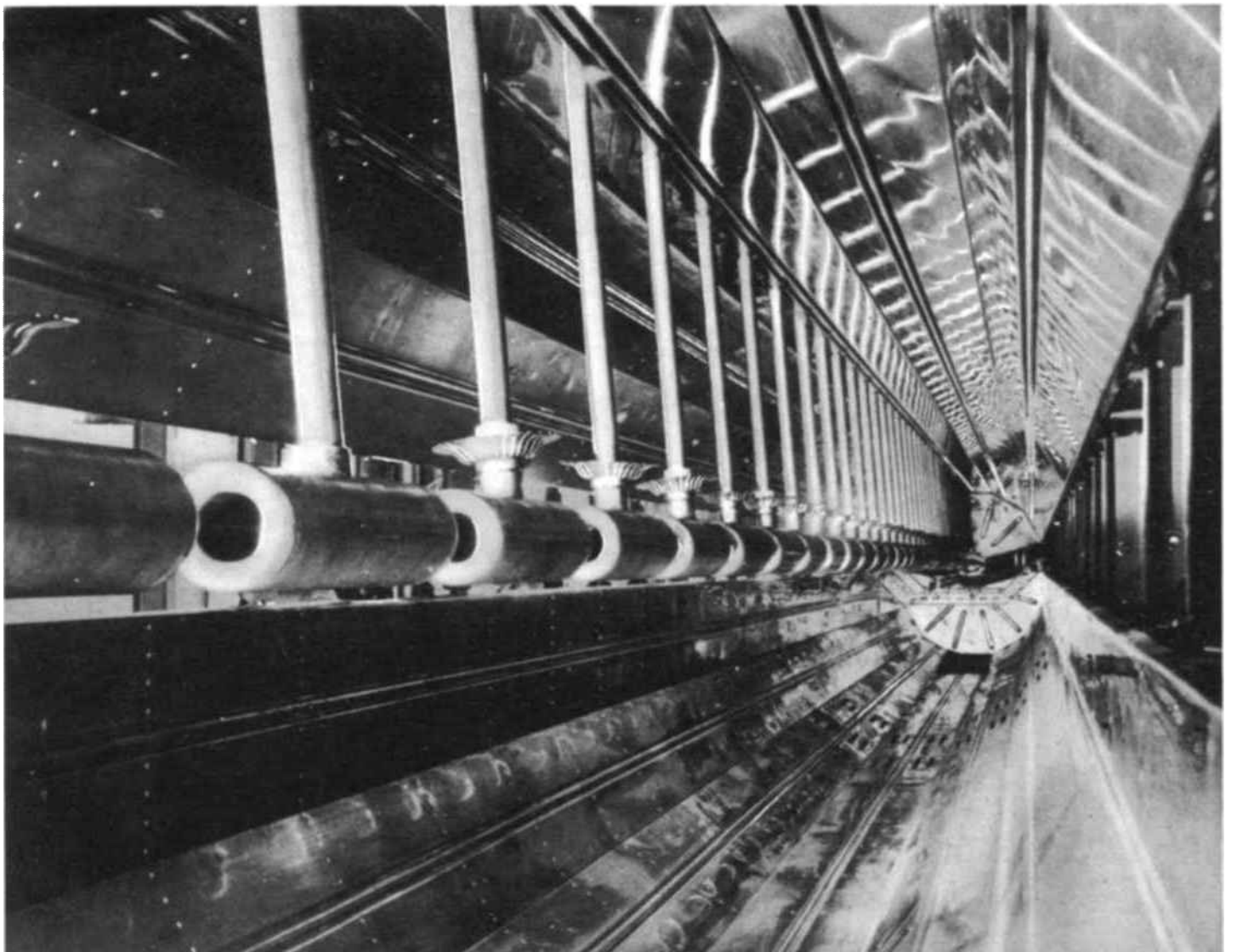
El método más sencillo para acelerar las partículas electrónicas o nucleares es hacerlas pasar a través de sucesivas placas electrostáticas cargadas. Cada una de éstas añade muchos centenares de voltios a la energía y a la velocidad de la partícula. La fotografía muestra el interior de dicho "acelerador lineal", en el Laboratorio de Radiación de la Universidad de California. La trayectoria de las partículas se desenvuelve a través de la serie de tubos, que se ve en el lado izquierdo.
