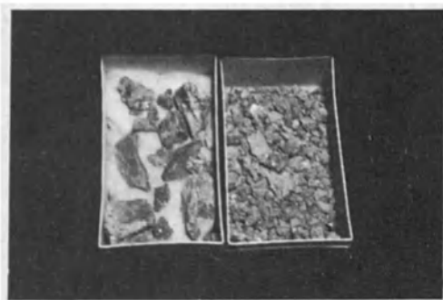
DOS MUESTRAS DE MINERALES DE URANIO vistas a la luz natural (fotos de arriba) y a la luz ultravioleta, provocadora de intensa luminosidad (foto de la derecha) que permite descubrir en los minerales radioactivos las partes más interesantes. (Clisés Copyright Kitrosser).
