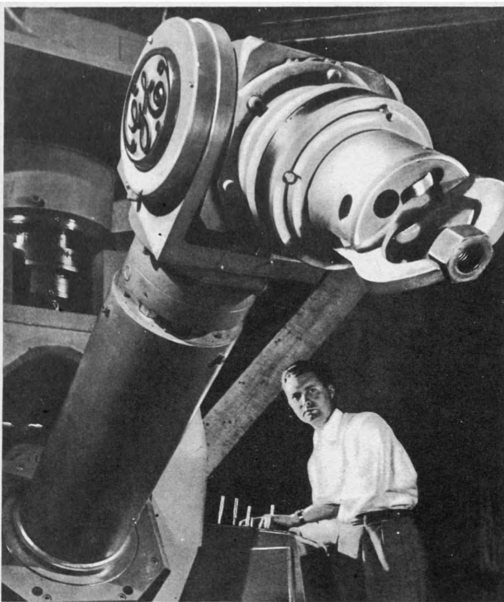
UNA MANO GIGANTE ha sido construida en los Estados Unidos para que los ingenieros atómicos puedan maniobrar desde lejos en cámaras peligrosamente radioactivas, sin necesidad de exponerse personalmente a los rayos. Este aparato llamado O-Man (abreviación de "overhead manipulator") pesa 15 toneladas y puede levantar cargas de 7.000 libras. Une la fuerza enorme a la destreza, pues sirve, entre otras cosas, para soldar, remachar, martillar y cortar. Manejado por palancas remotas, cada uno de sus movimientos puede ser controlado por un operario colocado en una vecina cámara acorazada. (Foto Life).
