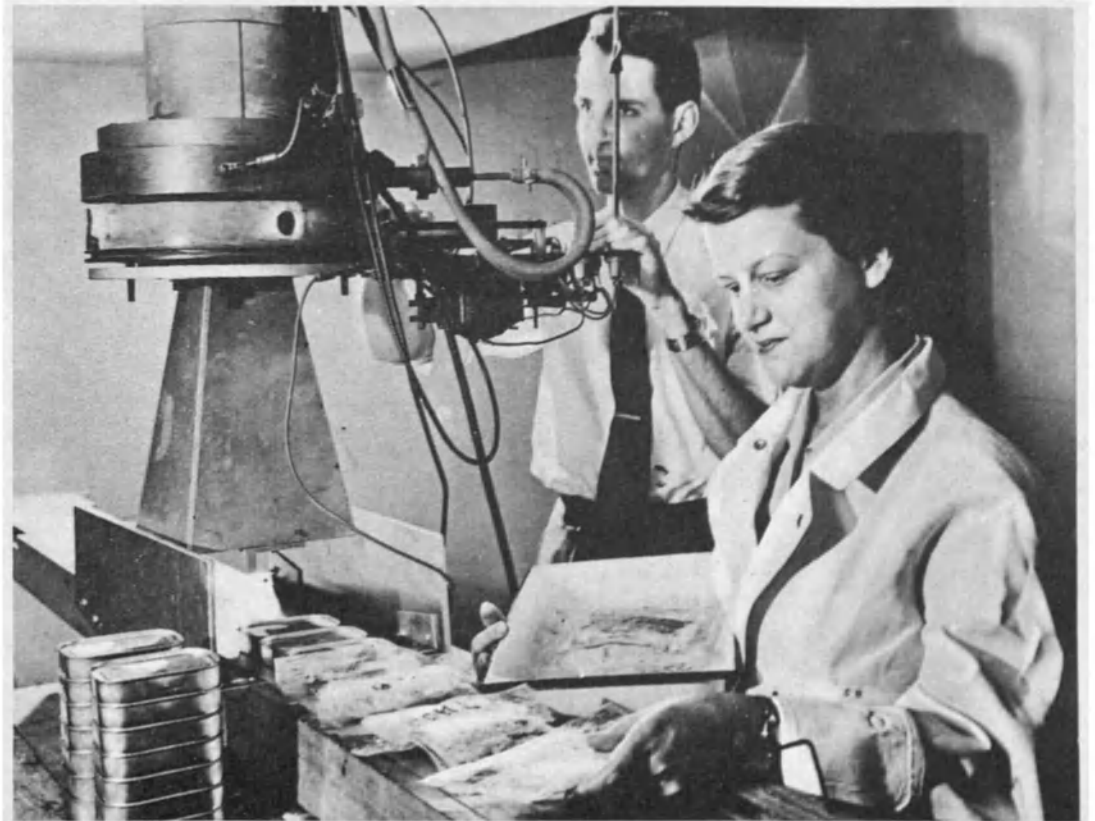
DESTRUCCION DE LAS BACTERIAS que corrompen los alimentos. En el Instituto de Tecnología de Massachusetts, se exponen filetes de bacalao a la acción de rayos intensos que exterminan en un segundo las bacterias corruptoras. Tomates, pescado y carne han sido esterilizados de esta manera y almacenados sin sufrir deterioración durante noventa días. Este método de conservación se halla aún en la fase experimental, pero puede desempeñar en el futuro una función importante en la reducción de la gran cantidad de alimentos que se pierden en el mundo. (Foto USIS).
