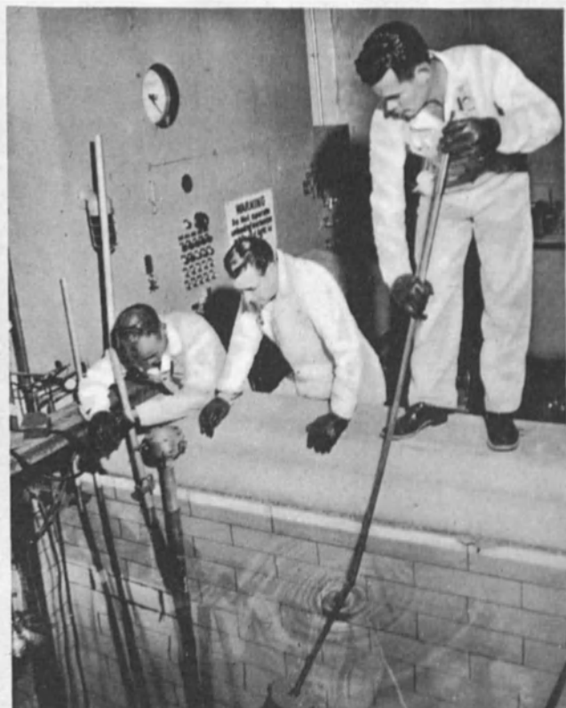
EN UN REACTOR ESPECIAL de un centro de investigación atómica de los Estados Unidos se somete a prueba el material. A la izquierda, se sumergen botes de carne en conserva en el agua del canal que conduce al reactor. La prueba mostrará si los recipientes y el contenido sufren el efecto de las radiaciones. A la derecha, los técnicos utilizan pinza de largos mangos para sacar un tubo de aluminio, lleno de cobalto radioactivo. (Foto USIS).
