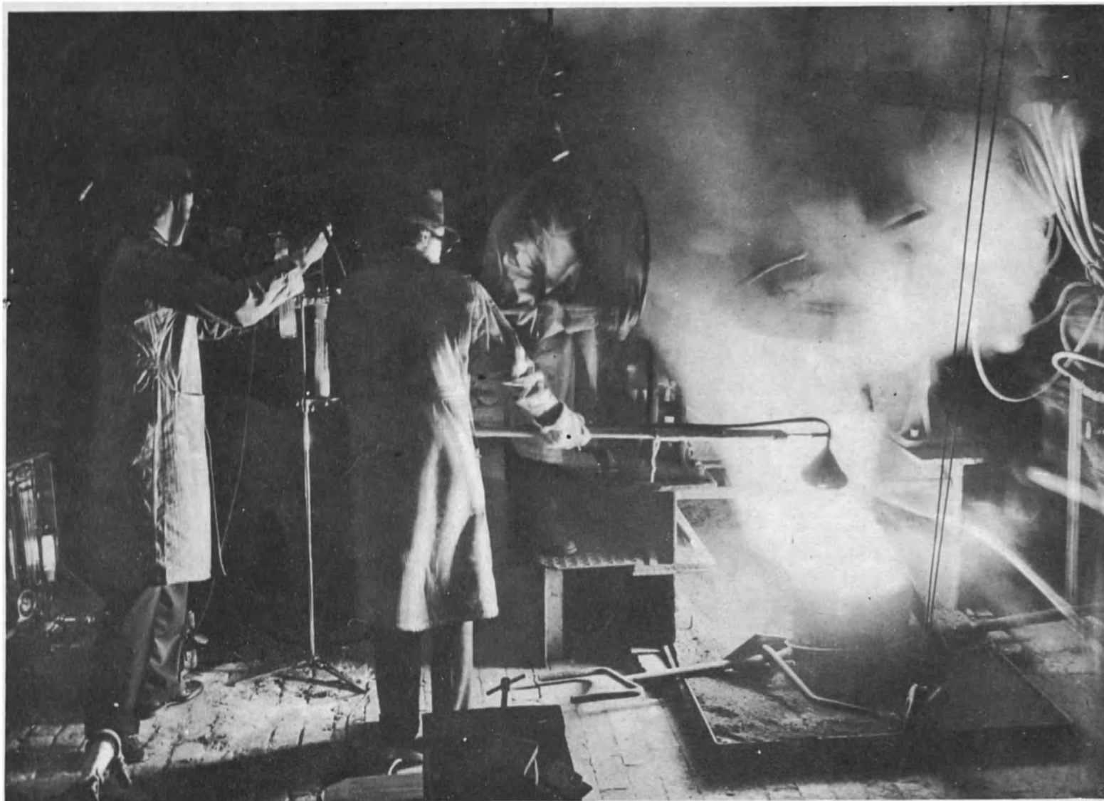
UNA FABRICA DE METAL de Michigan, Estados Unidos, emplea una gran cantidad de material radioactivo para sus experimentos industriales. Así, por ejemplo, se hizo una mezcla de mineral de hierro en polvo radioactivo con mineral en polvo común y se la sometió al calor del horno de fundición. La medición de la radioactividad de los gases desprendidos en este experimento, mostrado en la fotografía, inclinó a los técnicos a decidir la conveniencia de utilizar mineral en polvo para fundir el hierro. (Foto USIS).
