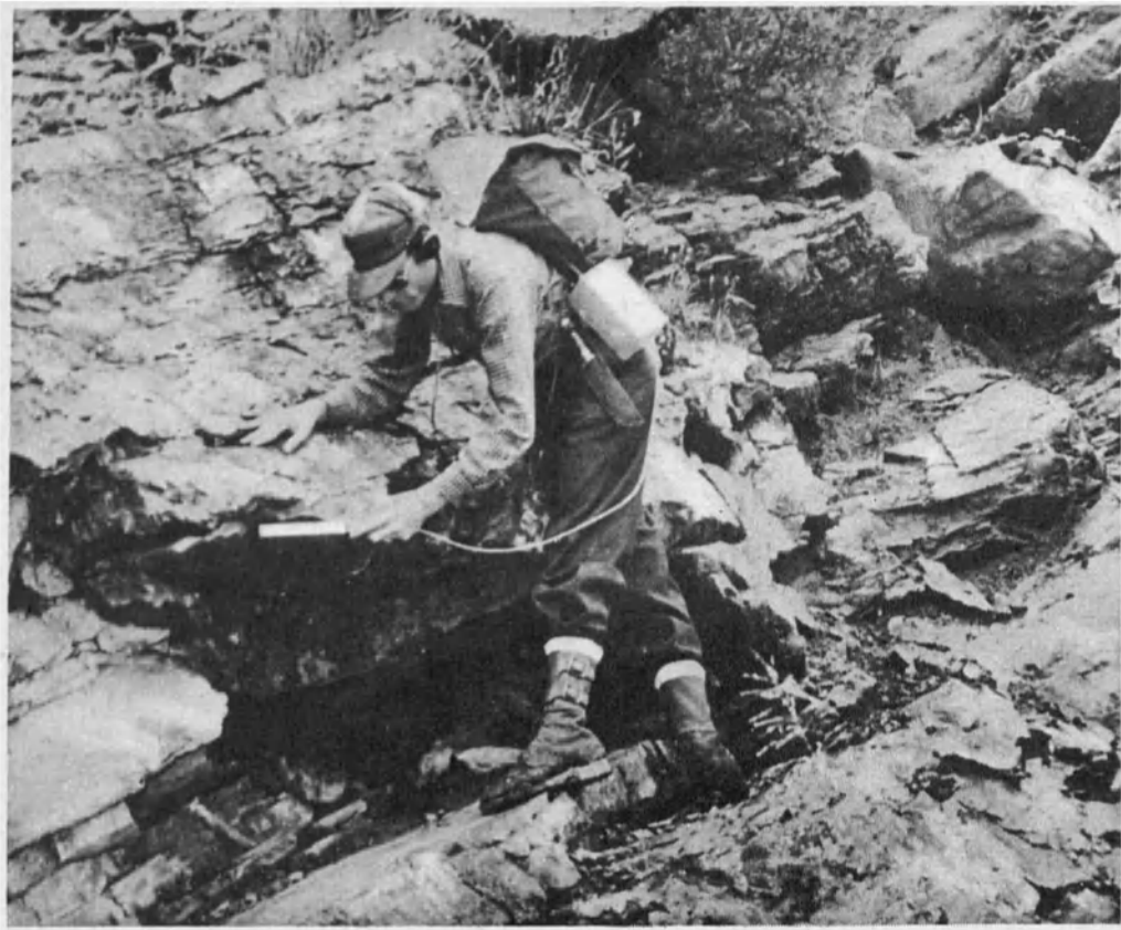
EL MODERNO BUSCADOR DE ORO. En los Estados Unidos, un buscador de uranio, provisto de un contador Geiger, recoge algunos elementos que permitirán establecer el mapa de la radioactividad de la región y de dirigir las investigaciones en tal o cual dirección. (Foto Usis.)
