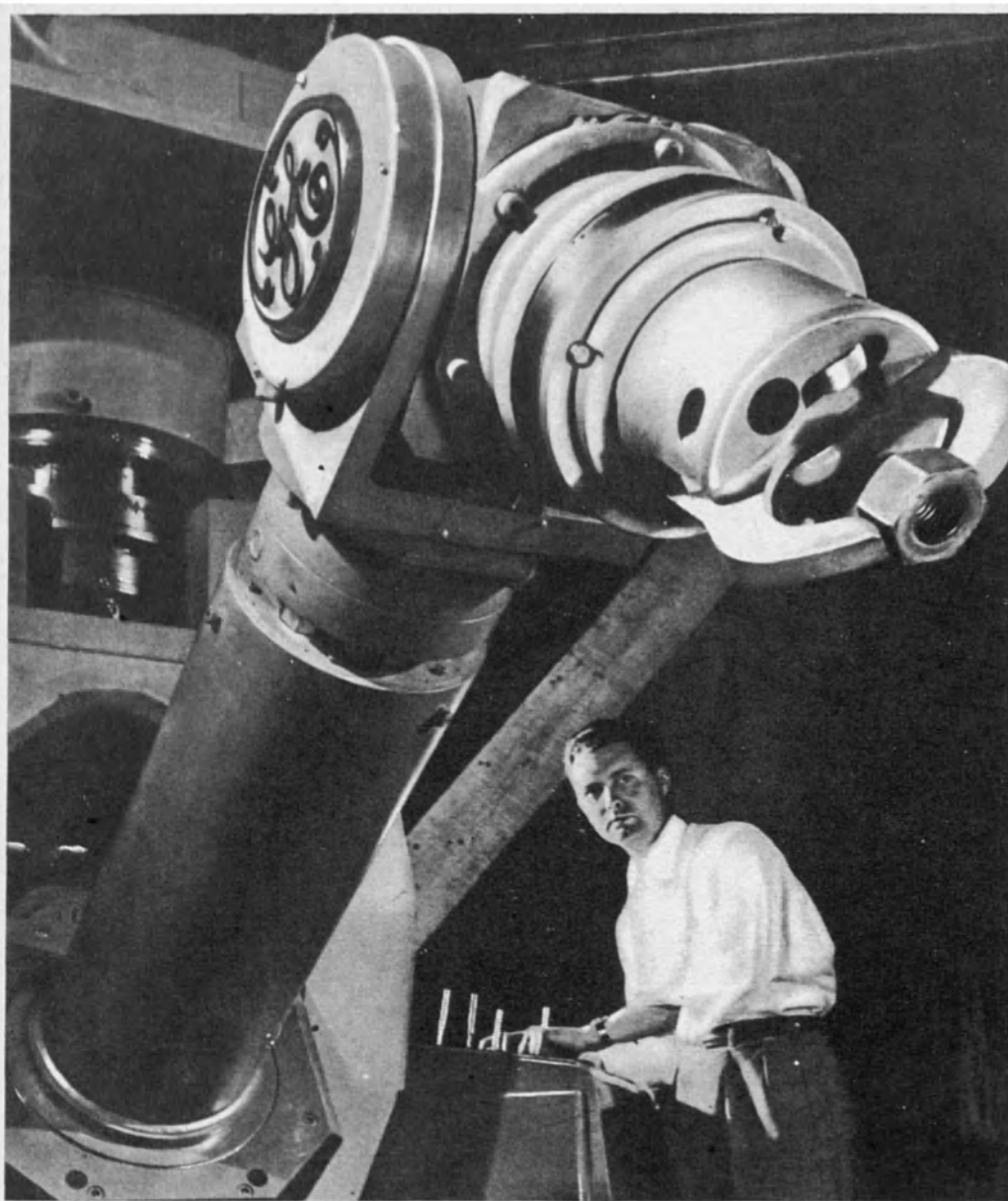
UNA MANO GIGANTE ha sido construida en los Estados Unidos para que los ingenieros atómicos puedan maniobrar desde lejos en cámaras peligrosamente radioactivas, sin necesidad de exponerse personalmente a los rayos. Este aparato llamado O-Man (abreviación de "overhead manipulator") pesa 15 toneladas y puede levantar cargas de 7.000 libras. Une la fuerza enorme a la destreza, pues sirve, entre otras cosas, para soldar, remachar, martillar y cortar. Manejado por palancas remotas, cada uno de sus movimientos puede ser controlado por un operario colocado en una vecina cámara acorazada. (Foto Life).
