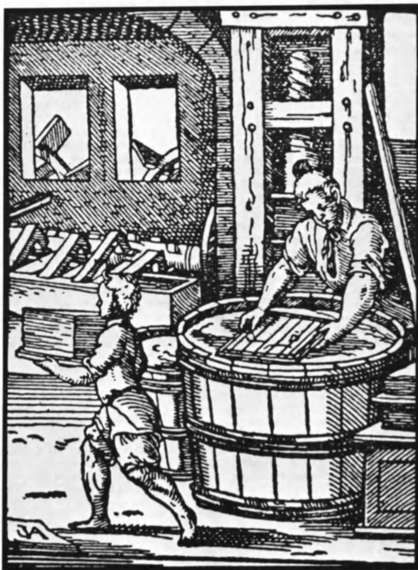
Este grabado en madera de Jose Annam, impreso en Frankfurt en 1568, es la ilustración más antigua que se conoce sobre la fabricación del papel en Europa. En él se advierte la notable similitud de las herramientas y de la técnica empleados por los fabricantes de papel europeos con las que se utilizaban varios siglos antes en China (véanse especialmente las ilustraciones de las páginas 4 y 5). (Ilustraciones tomadas de Old Papermaking , por Dard Hunter, Mountain House, 1923.)
