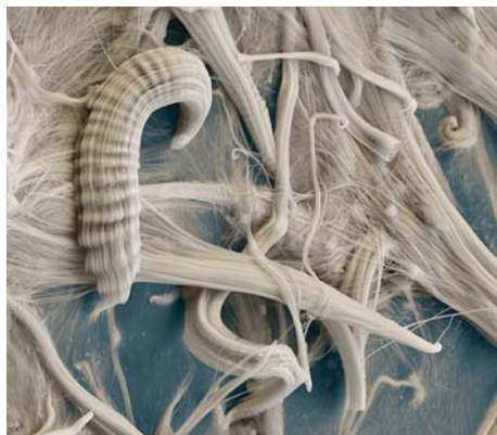
🔗 Fibras de cristales de barita. La barita se utiliza principalmente en la industria petrolera, la medicina (radiografías del tubo digestivo) y la construcción (hormigones pesados contra las radiaciones). © SPL
