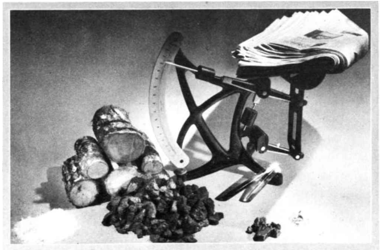
La foto muestra — a la izquierda de la balanza — las materias primas que entran en la composición de un diario que pesa 900 gramos (se trata de una edición de gran número de páginas, como aparece los domingos en algunos países). Entre esas materias primas hay: 3 libras de madera de pinabete, 30 gramos de azufre, 30 gramos de cloruro de calcio, 45 gramos de cal viva y un kilogramo de carbón, que es necesario para convertir los colorantes rojo y azul necesarios a un solo ejemplar del periódico. Todas estas materias pesan en conjunto ¡más de dos kilogramos!
