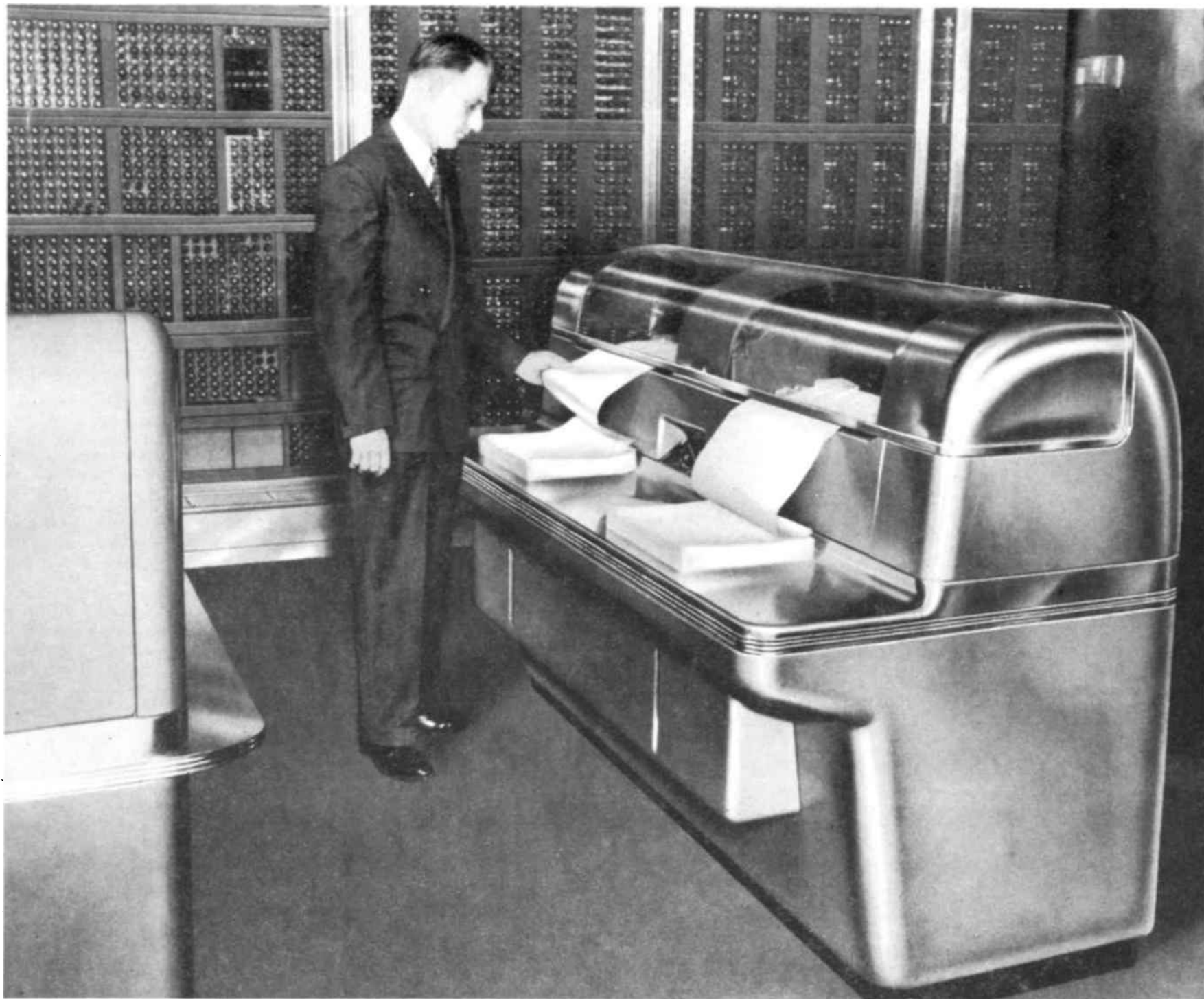
COMPROBACION DOBLE : Esta calculadora moderna es, de hecho, dos calculadoras idénticas. Cada operación se hace simultánea e independientemente dos veces, y cada una anota los resultados de la otra. Cualquier disparidad en sus resultados determina en el acto la interrupción del trabajo. La impresión se hace a una velocidad de 24.000 dígitos por minuto, suministrando una relación de los resultados a medida que estos van obteniéndose, lo que permite a los científicos seguir un cálculo y modificar sus intenciones a la luz de los resultados parciales.
