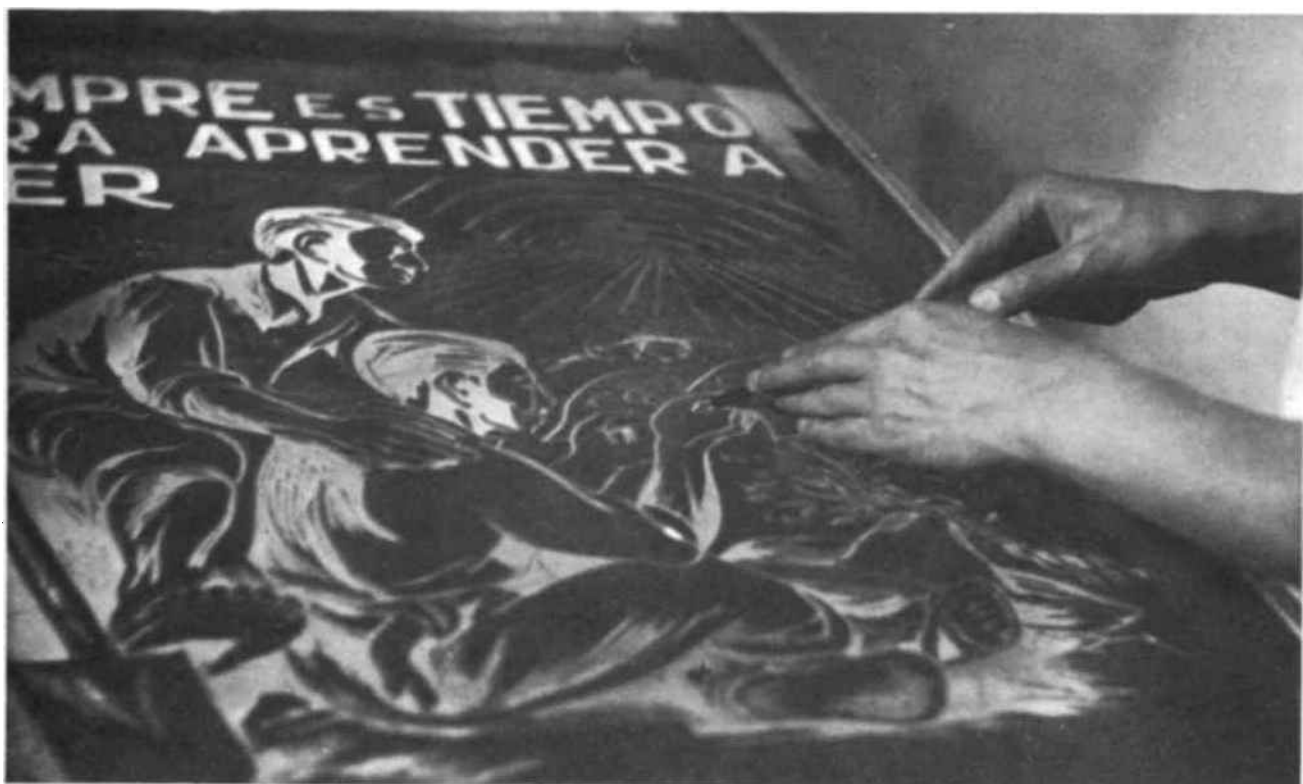
El dibujante graba las líneas del cartel directamente sobre una mezcla de parafina y cera de abeja que se ha vertido en una chapa de vidrio, y quita la cera hasta llegar a éste (véanse los diagramas a la derecha).
