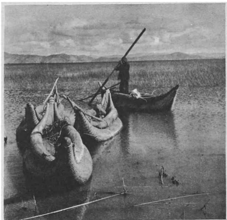
A LOS INDIOS del Lago Titicaca les hace falta la madera. Para navegar en este lago —situado a 3.900 metros de altura— construyen con los largos tallos de la totora , especie de junco lacustre, pequeñas embarcaciones bastante estables para afrontar las tremendas tempestades que se desencadenan de pronto en esos parajes. (Foto Almas.)
