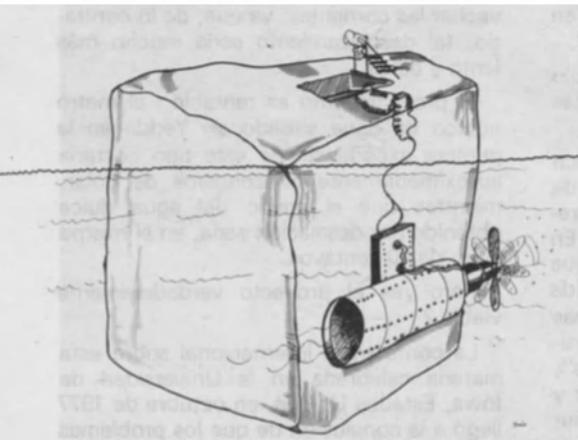
Otro procedimiento, actualmente en estudio, es el de la autopropulsión del iceberg mediante la instalación de hélices o de ruedas de paletas en el iceberg, bajo la línea de flotación. La energía para su funcionamiento provendría, bien de motores colocados sobre el propio bloque de hielo, bien de embarcaciones que lo escoltarían.
