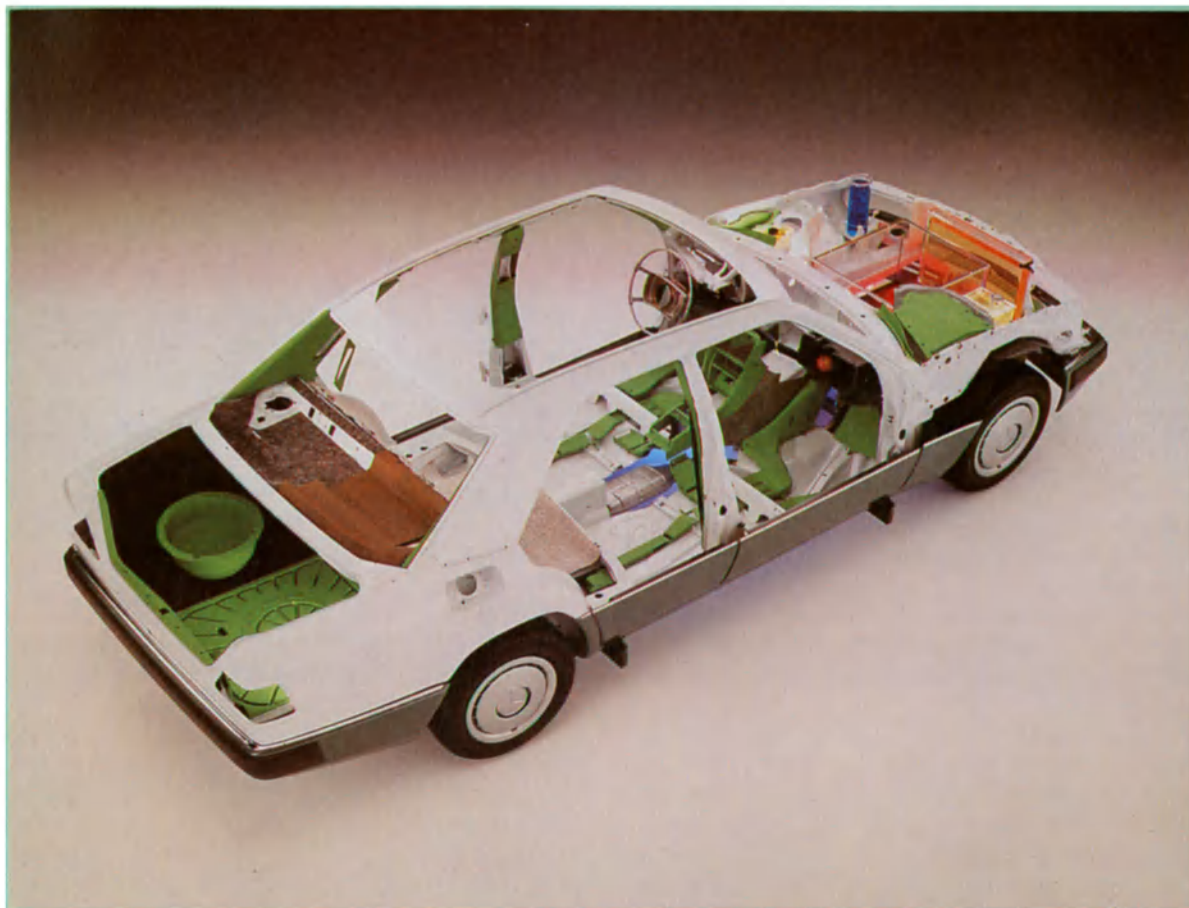
En este modelo de automóvil, las partes reciclables son de color verde.
