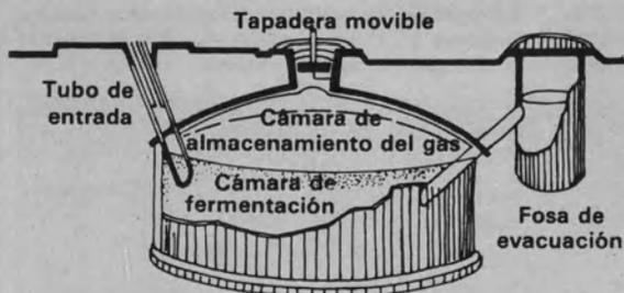
En la foto de arriba, una mujer india cocina con biogás. A la derecha, una cuba india de digestión para la producción de biogás. Debe añadirse agua para el buen funcionamiento de la instalación, lo que puede representar una rémora seria allí donde el agua escasea. Con unos cinco millones de digestores de biogás instalados, China ocupa el primer puesto en la materia entre los países del mundo. Arriba, corte transversal de un digestor chino de biogás.
