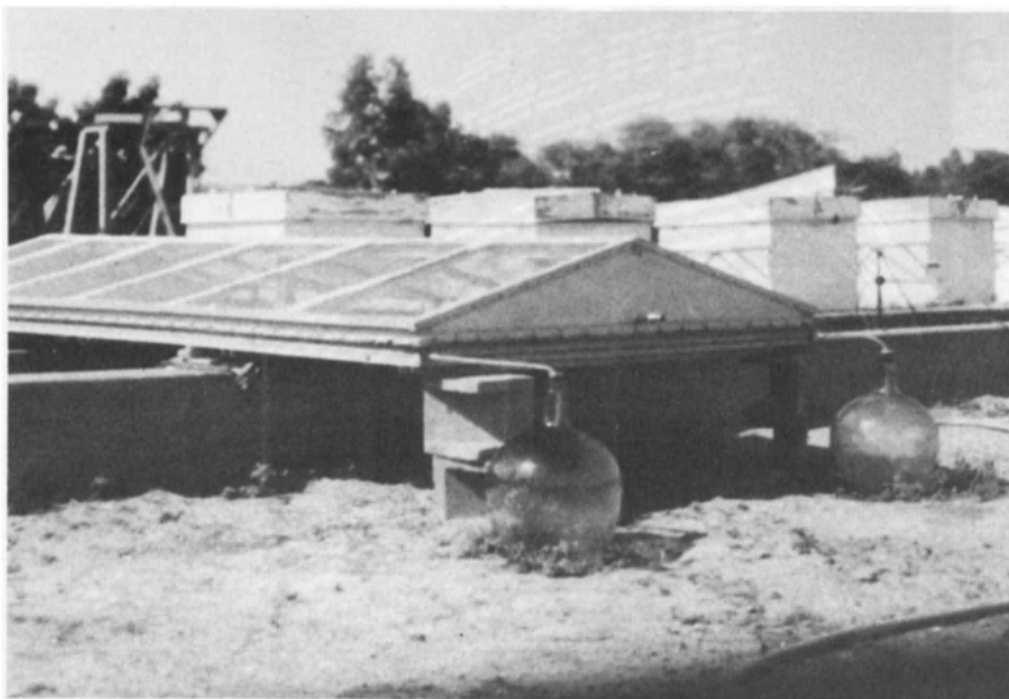
Destilador solar portátil ideado y fabricado por la Oficina de Energía Solar (ONERSOL) de Niamey, Níger. Los pequeños destiladores solares, con una capacidad menor de 200.000 litros de agua al día, tienen un importante papel que desempeñar en varias regiones del África occidental, como la zona costera de Mauritania y los distritos septentrionales de Malí y Níger donde el agua disponible es salobre. Sin embargo, hay por el momento pocas probabilidades de que las instalaciones de desalamiento solar puedan competir con las que funcionan a base de combustibles tradicionales.
