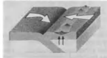
Zona oceánica de reducción. Una placa empuja por debajo a otra. El borde de una de ellas, empujado hacia abajo, se incrusta en el manto donde se funde y se recicla.
