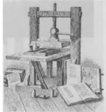
8. Reconstrucción de la prensa de Gutenberg realizada en Leipzig en el siglo XIX. La prensa consta de una superficie inferior fija, la platina, y de una superior móvil, el cuadro. La forma, o sea el conjunto de tipos que constituyen un texto, se encerraba en un marco metálico llamado rama , se entintaba, se cubría con una hoja de papel y se sometía a presión entre las dos superficies.
