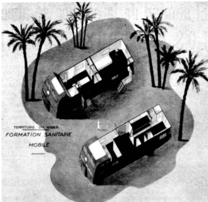
Para llegar a las regiones más apartadas de la Nigeria francesa, la «misión sanitaria móvil» dispondrá de dos camiones, especialmente fabricados para ella. El primero (arriba, a la izquierda) constituye una verdadera clínica rodante: lleva «un consultorio», un aparato de radiografías y una mesa de operaciones para casos urgentes. Los miembros de la expedición sanitaria se alojarán en el segundo camión, especie de vivienda, que puede compararse ventajosamente con un departamento moderno.
