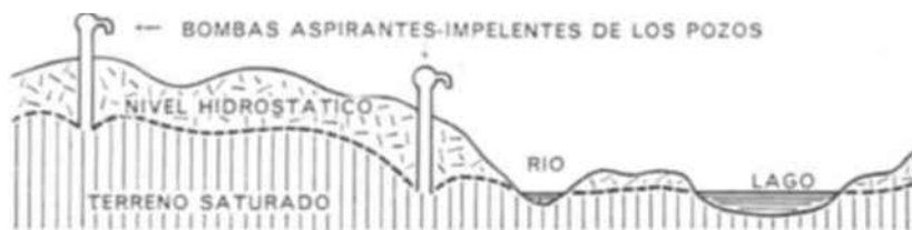
SECCION DE UN TERRENO , que muestra la capa de agua con relación a su superficie. Los pozos, que deben ser perforados hasta un punto por debajo del nivel líquido, hacen descender éste en su vecindad. El estado de la capa de agua varía a menudo, dependiendo de abastecimiento y la demanda hidráulica. Por lo general, su índice inferior se acusa en otoño.
