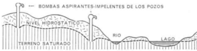
SECCION DE UN TERRENO , que muestra la capa de agua con relación a su superficie. Los pozos, que deben ser perforados hasta un punto por debajo del nivel líquido, hacen descender éste en su vecindad. El estado de la capa de agua varía a menudo, dependiendo de abastecimiento y la demanda hidráulica. Por lo general, su índice inferior se acusa en otoño.
